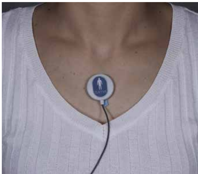
Figura 4: Sensor de ronco fixado abaixo do esterno.
