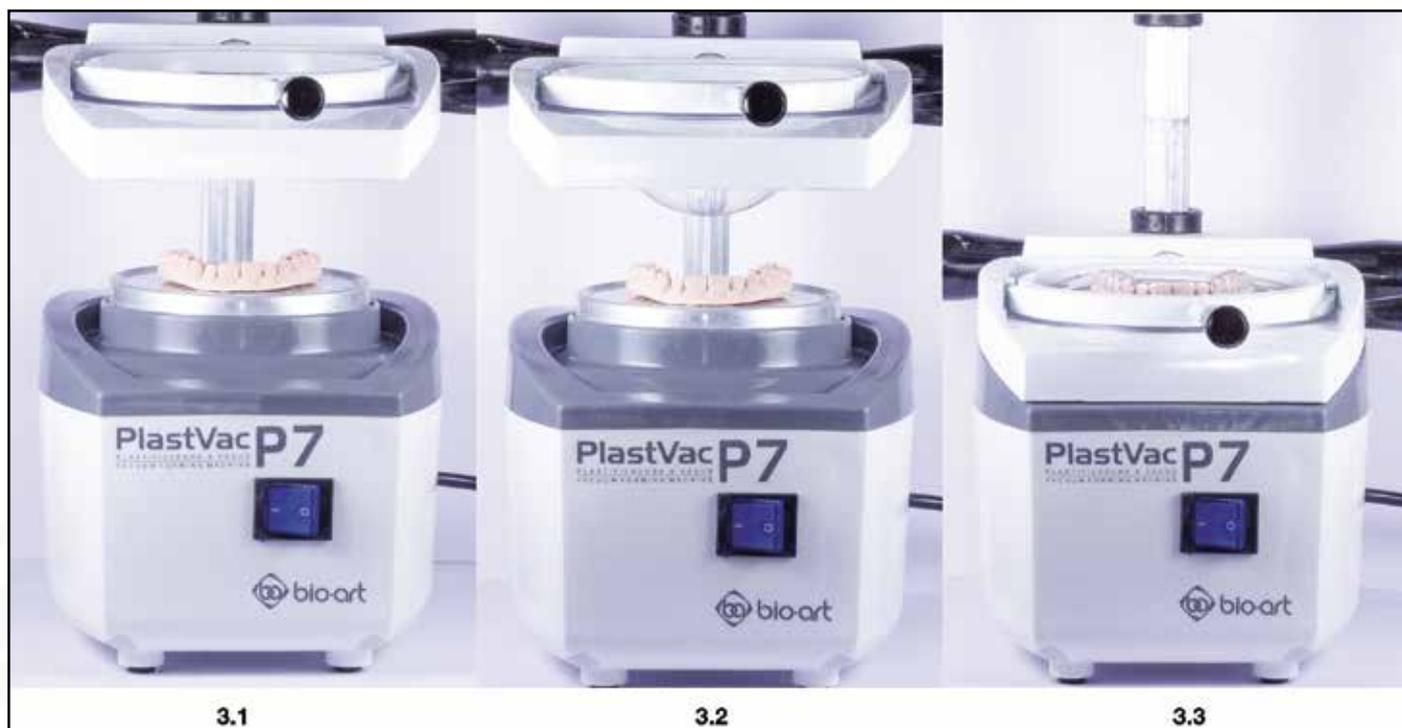
Figura 3: Sequência utilizando a plastificadora a vácuo (PlastVac P7 - BioArt®). Note o modelo de gesso colocado sobre sua base, o recorte do modelo de gesso é fundamental para que haja maior contato entre a placa e a superfície de vácuo. 3.2: Ponto ideal onde deve-se iniciar a decida da placa. 3.3: Plastificação concluída, pode-se remover o modelo com a placa do equipamento após 1 minuto de vácuo e seguir sua remoção do modelo.
